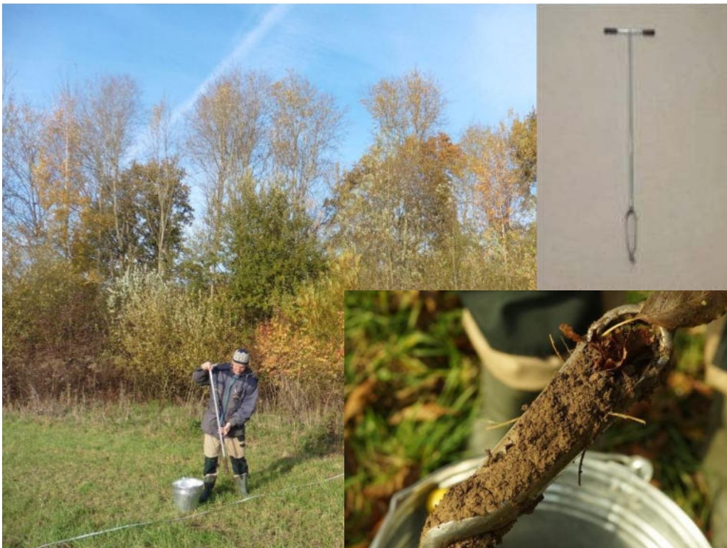
Abbildung 2. Probenahmeschnecke zur Entnahme von Bodenproben
